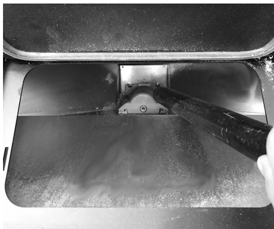
Fig. 26 - Reiniging van de voorraadbak en transportschroef
