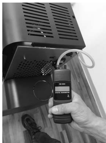
Fig. 48 - Aansluiting digitale drukregelaar
