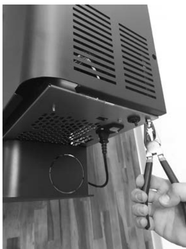
Fig. 47 - Carter verwijderen
