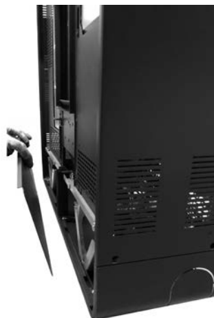
Fig. 37 - Loshaken onderste beugel
