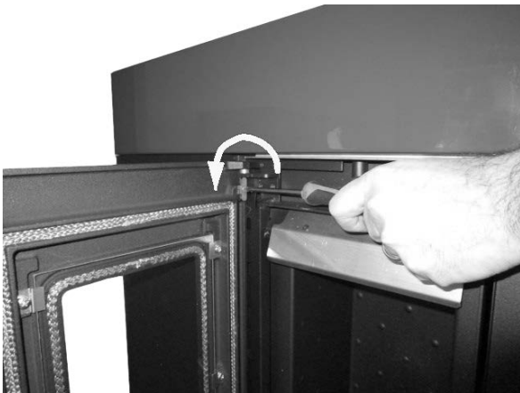
Fig. 27 - Verwijdering van de schroeven
