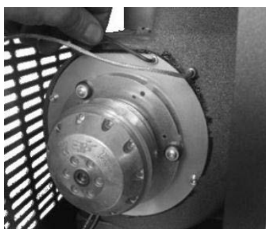
Fig. 54 - Reiniging rookgassenafzuiger: fase 1
