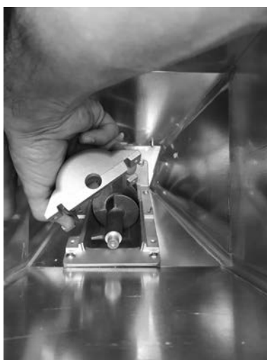
Fig. 50 - Verwijdering van het omhulsel
