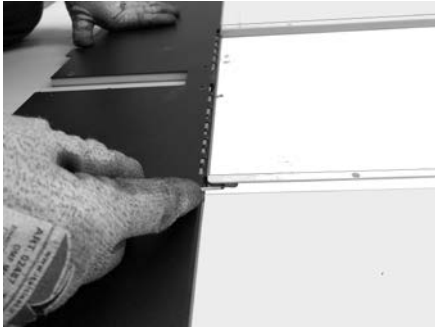
Fig. 39 - Doorbuigen tanden
