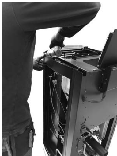
Fig. 41 - Remoção do compensador
