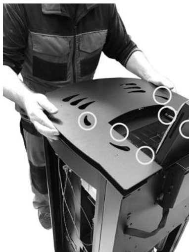
Fig. 40 - Remoção da tampa
