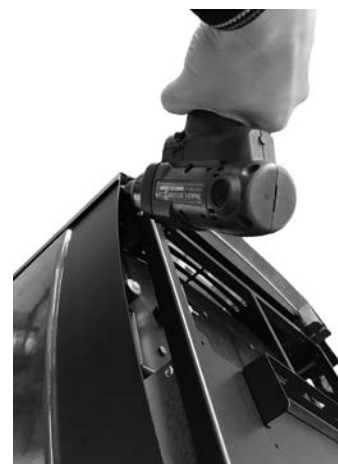
Fig. 45 - Fixar o compensador
