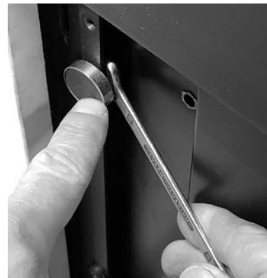
Fig. 30 - Regular o ímã e bloqueie com a chave
