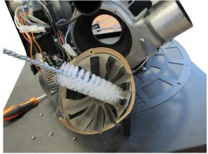
Fig. 104 - Fume fan cleaning: phase1
