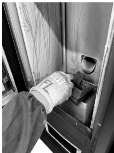
Fig. 91 - Usunąć ruszt paleniskowy
