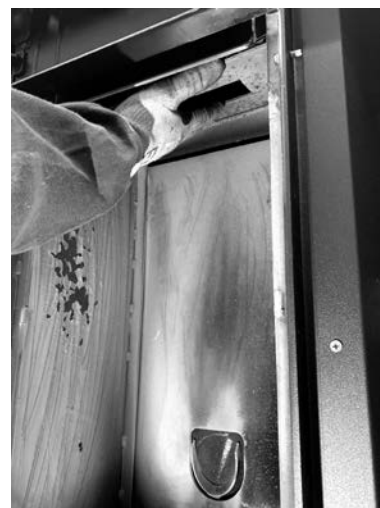
Fig. 98 - Usunąć przednią część paleniska 1
