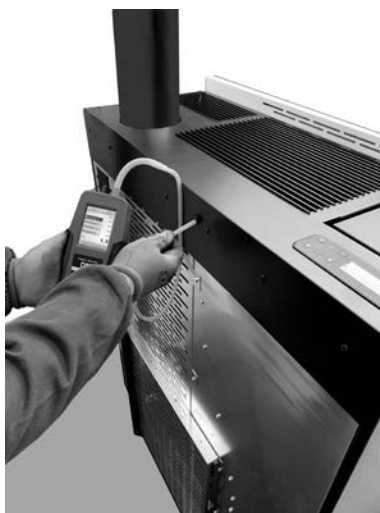
Fig. 90 - Podłączenie presostatu cyfrowego (Mithos³ Plus12/14)
