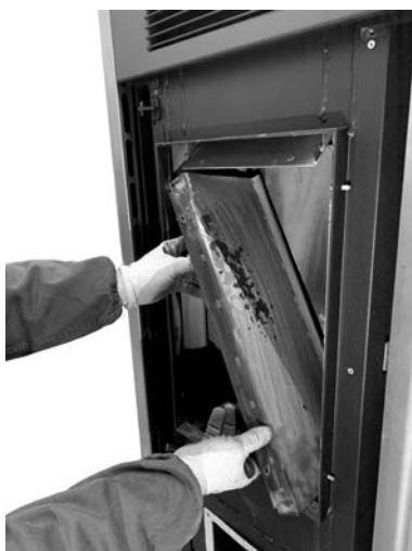
Fig. 100 - Usunąć boczne ścianki
