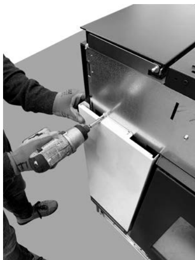
Fig. 36 - Przymocować płyty boczne
