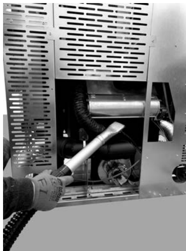
Fig. 109 - Czyszczenie wentylatora (Mithos³ Plus 12/14)
