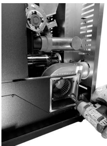
Fig. 62 - Usunąć śruby wentylatora
