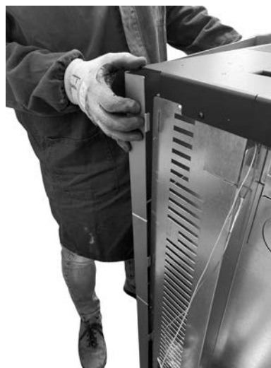
Fig. 27 - odczepić ściankę boczną
