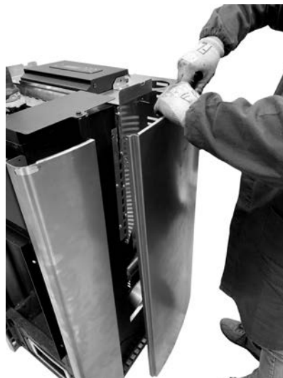
Fig. 29 - Usunąć boczne ścianki
