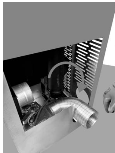
Fig. 73 - Przekręcić wąż
