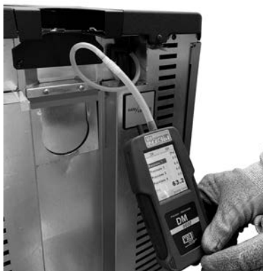
Fig. 89 - Podłączenie presostatu cyfrowego (Atena³ Plus12/14 - Duke 12/14 At - Saba 12/14)
