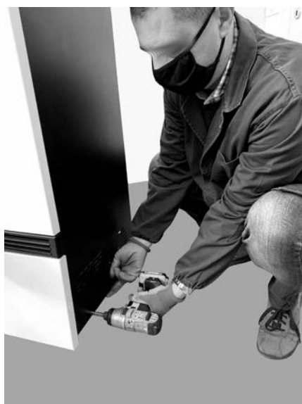
Fig. 45 - Usuwanie śrub
