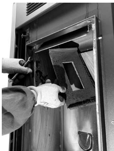
Fig. 99 - Usunąć przednią część paleniska 2
