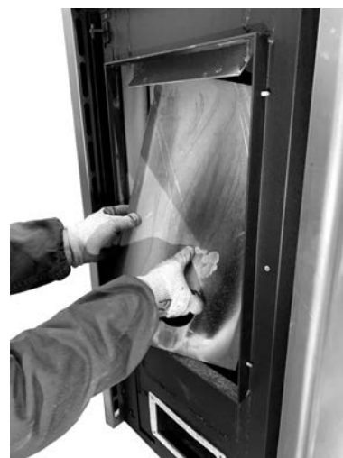
Fig. 101 - Usunąć tylną ściankę paleniska
