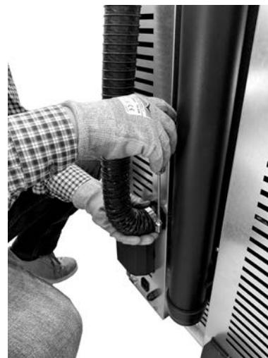
Fig. 56 - Przyczepić rurę powietrza spalania
