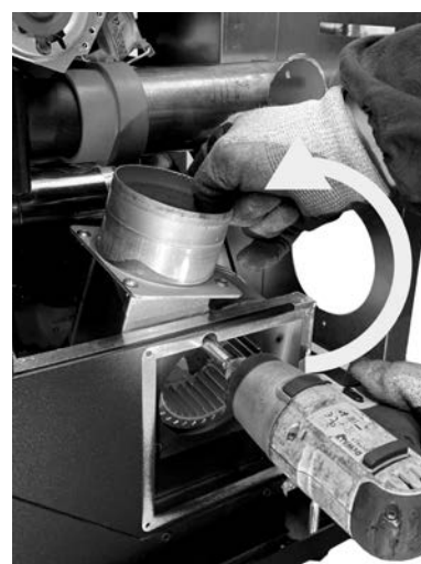
Fig. 63 - Przekręcić wentylator
