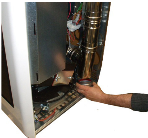
Fig. 102 - Czyszczenie czopucha
