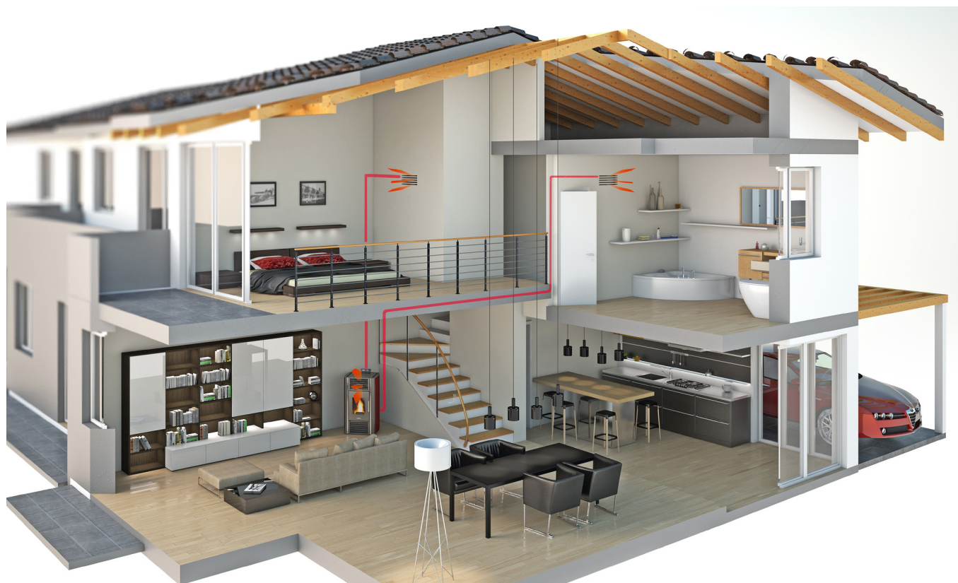
Fig. 68 - Przykład układu kanałowego
