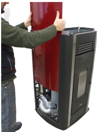
Fig. 46 - Wkładanie ścianki bocznej
