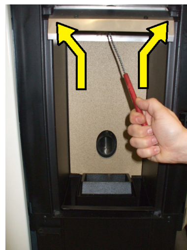
Fig. 98 - Wyczyścić obydwa przewody
