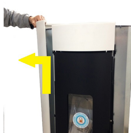
Fig. 89 - Usuwanie ścianek bocznych
