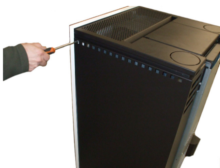
Fig. 75 - Usuwanie śruby górnej
