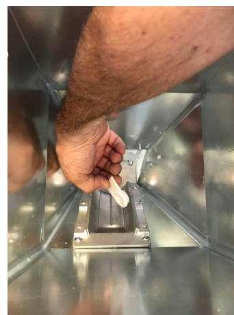
Fig. 74 - Usuwanie łożyska
