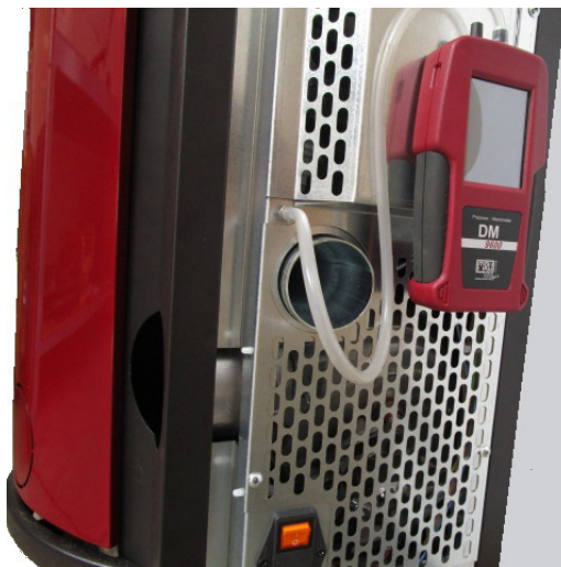
Fig. 55 - Podłączenie presostatu cyfrowego
