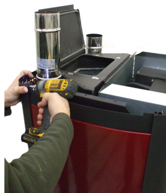
Fig. 47 - Ponowne umieszczanie górnych zakrzywionych profili
