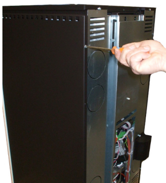
Fig. 76 - Usuwanie śruby tylnej
