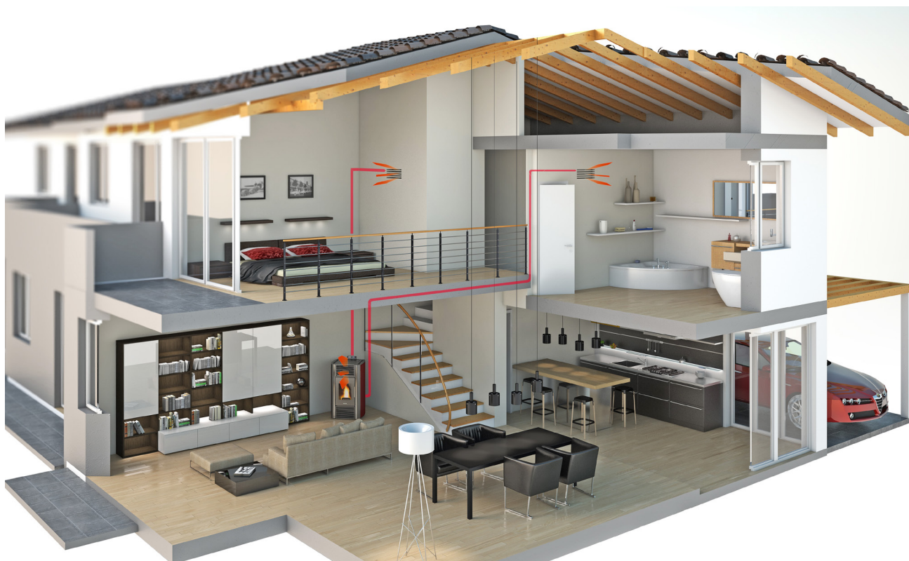
Fig. 60 - Przykład układu kanałowego
