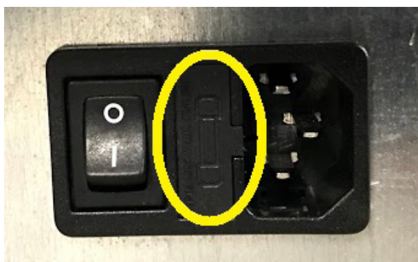
Fig. 108 - Drzwiczki z bezpiecznikami do wyjęcia
