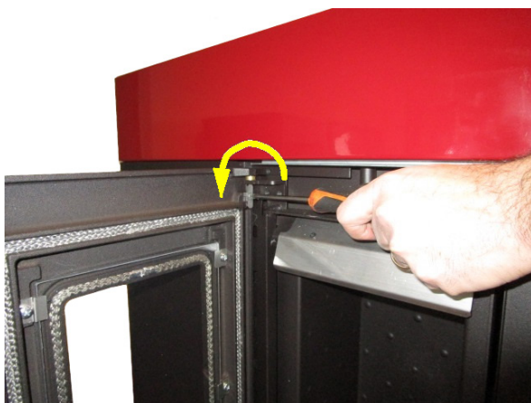
Fig. 52 - Usuwanie śrub
