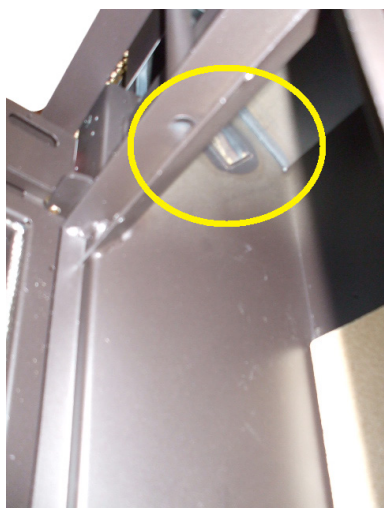
Fig. 96 - Przejście spalin
