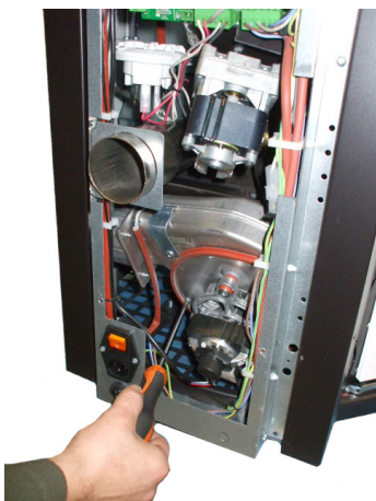
Fig. 104 - Czyszczenie odciągu dymu: faza 1
