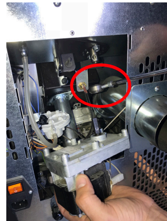
Fig. 72 - Usuwanie motoreduktora
