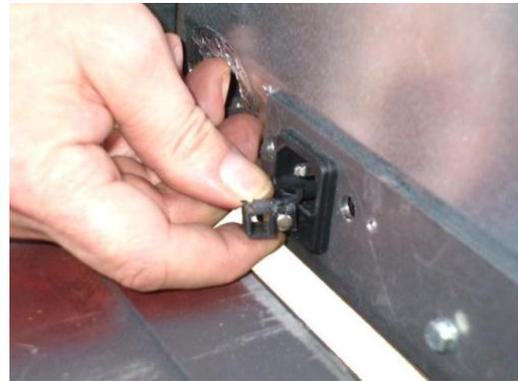
**Fig. 66 - Substitution du fusible**
