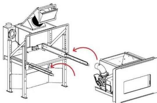
**Fig. 21 - Enclenchement de l'insert sur les glissières**
