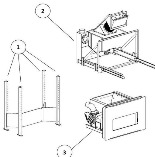
Fig. 25 - Structure séparée
