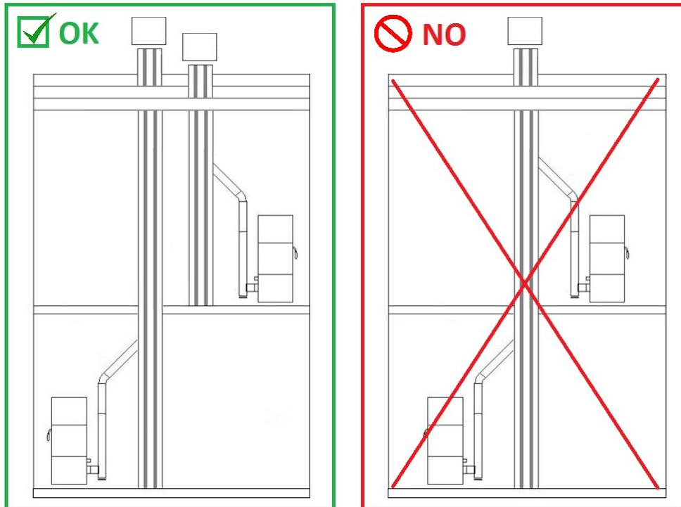
Fig. 12 - Exemples des installation correcte
