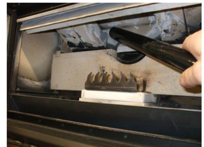
Fig. 48 - Nettoyage de la partie supérieure des tuyaux dans la chambre de combustion
