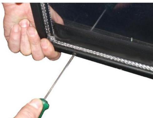
Fig. 57 - Extraction des vis
