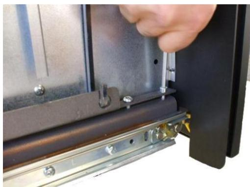
Fig. 16 - Vis antérieure de fixation insert
