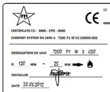
Fig. 3 - Exemple de plaquette
