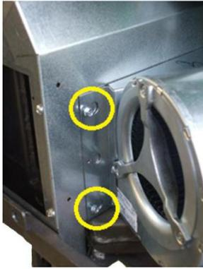
**Fig. 63 - Vis de blocage ventilateur**
