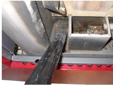
Fig. 32 - Limpieza alojamiento cajón de cenizas
