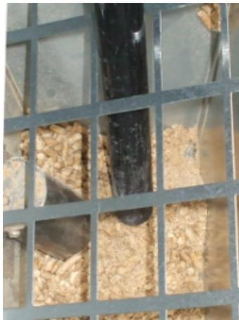
Fig. 34 - Limpieza depósito y coclea
