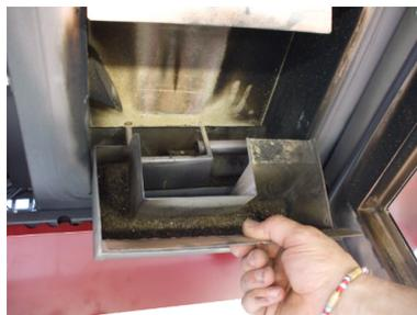
Fig. 29 - Extracción del cajón de cenizas
