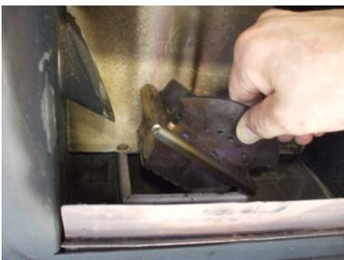
Fig. 28 - Extracción del brasero
