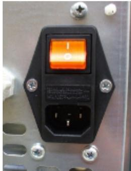
Fig. 22 - Toma de corriente con interruptor general
