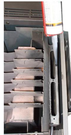
Fig. 45 - Colocación de la silicona
