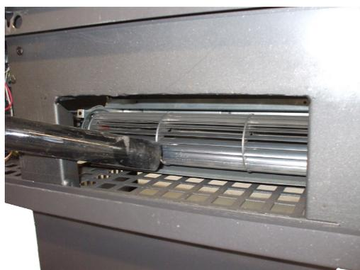
Fig. 41 - Limpieza ventilador ambiente
